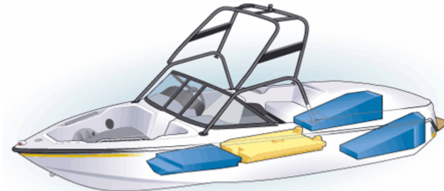
Ballasts à eau de 820 livres (369kg), 2 arrières (234kg) et un central (135kg).
